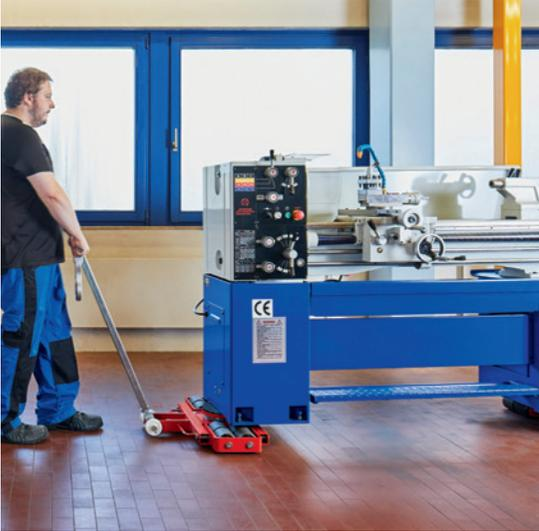
La rueda de nuevo desarrollo tiene cuatro rodamientos de bolas y consiste en un núcleo de aluminio dentado encapsulado con poliamida. El enclavamiento del núcleo y la banda de rodadura es crucial. Proporciona una superficie de conexión mayor y al mismo tiempo asegura que los dos componentes se enclaven.
