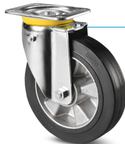
Automatické směrové vyrovnání Tato vidlice je vybavena dvěma pružinami pro automatické vyrovnání v pozici 2 x 180°. Je perfektní pro automaticky řízené vozíky. Kdykoli je kolo zdviženo, automaticky se vyrovná ve směru jízdy. Toto zamezuje poškození a snižuje náklady na údržbu. Kontaktujte nás pro radu, jak upravit pozici 2 x 180° Vaším potřebám.
