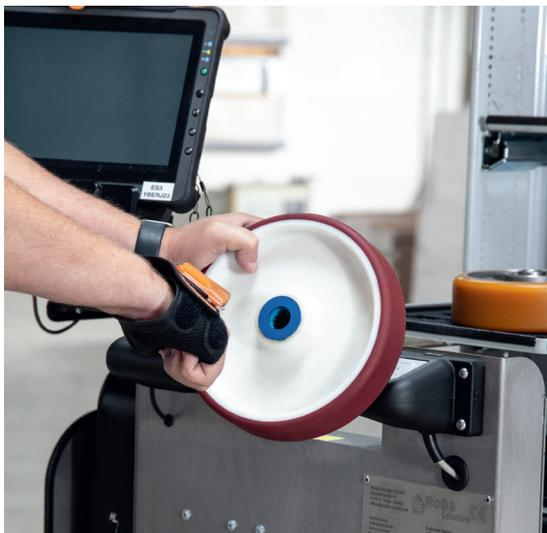
NoBa Solution a bridé la vitesse du système E-Drive de TENTE à 5 km/h. De cette façon, même si un travailleur heurte le chariot à l'avant, le chariot s'arrêtera automatiquement sans causer de blessures. Des pare-pieds devant les roulettes préviennent également les accidents potentiels.
